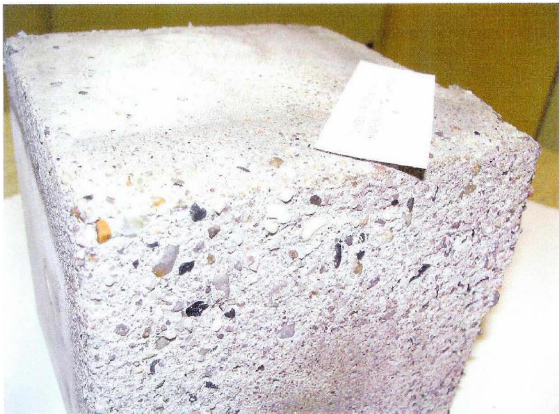
Depus într-o solu ie SO 4 , de 36000mg/l, 4 luni, 0=mostre de control (f r aditivi)
