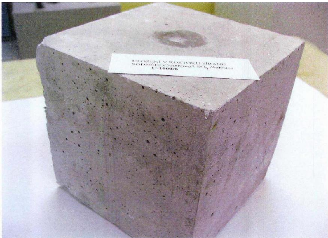
Depus într-o solu ie de SO 4 , de 36000mg/l, 4 luni, Mostra 8 cu C-1000
